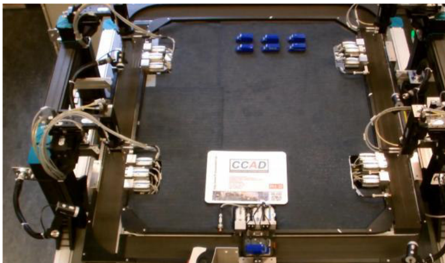
Bild 26: Montagestation für Modellautos mit fünf Teilstationen (CICS-Demonstrator 1)
